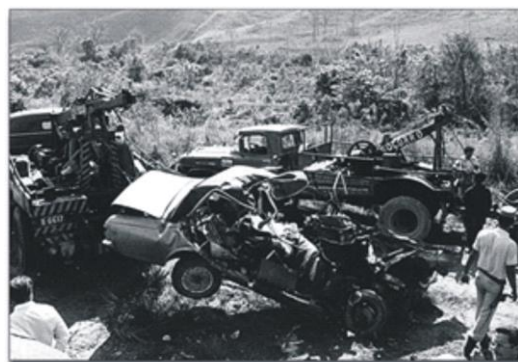
Ilustração nº 26 – Mostra o Opala sendo guinchado do local do acidente, após a realização dos exames periciais no local. A seta indica a região do veículo que teve contato com a estrutura do guincho durante a montagem e o transporte.
