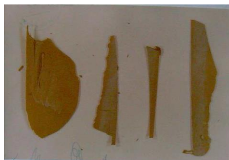
Ilustração nº 08 – Mostra os fragmentos de tinta recolhidos do Opala para confronto com as impregnações existentes no Ônibus.
