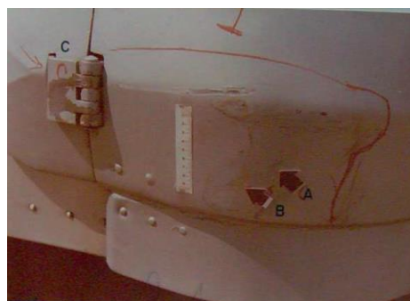
Ilustração nº 09 – Mostra as impregnações de tinta compatíveis com a do Opala na estrutura do Ônibus.
